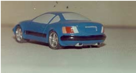
(57) Մեխանիկական շարժաբերով (իներցիոն սկզբունքով աշխատող, հետեի տանող անիվներով) օժտված խաղալիք ավտոմեքենա • «BMW» ֆիրմայի ավտոմեքենաներին (հատկապես սպորտային ոճի) հատուկ տարրեր եւ ընդհանրական պլաստիկ լուծումներ գուգակցող, ամբողջական իրանով, երկտանի շասսիով եւ երկդռնանի թափքով հորին-
